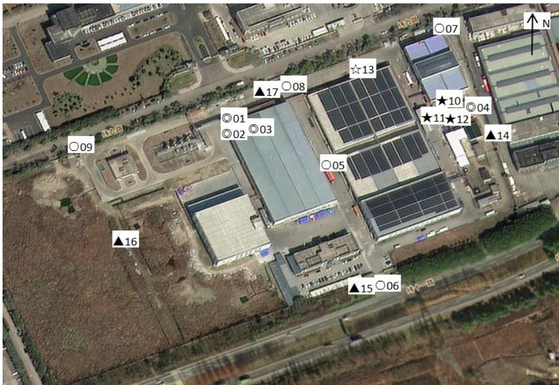
注：★为废水采样点，☆为雨水采样点，◎为有组织废气采样点，○为无组织废气采样点，▲为噪声检测点。
